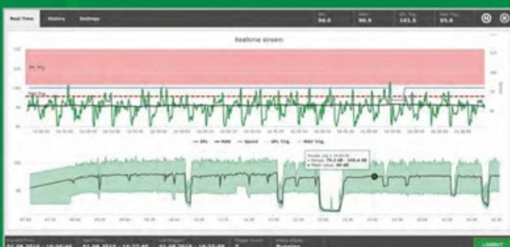
SPL-Messkurve (oben): Um 16:35:59 überschreitet der Schallpegel den gesetzten Grenzwert (roter Bereich), der Vorschub (blaue Linie) wird sofort kurzzeitig verlangsamt. So wird ein Schaden an den Sägeblättern effizient verhindert.
