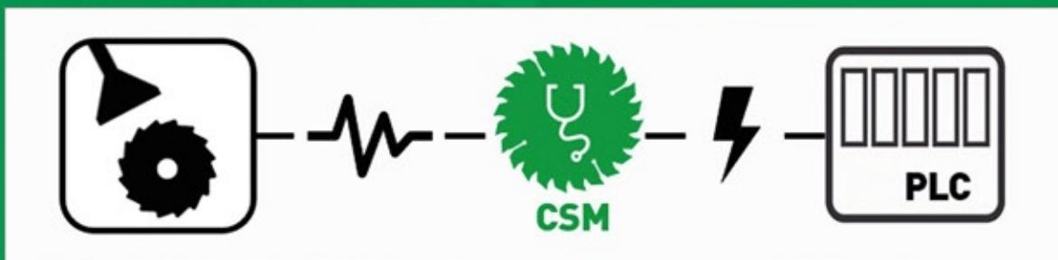
Die Systeme umfassen ein hochsensibles Mikrofon, ein Elektronikteil und die CSM Software, die in die bestehende Steuerungssoftware integriert wird.
